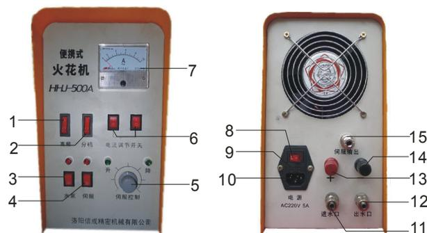
主机箱操作面板示意图 (图 3)
